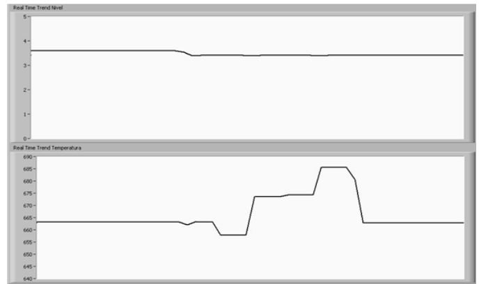
FIG 8. Gráfico de tendencia histórica del SCADA. (a) Nivel (superior), (b) Temperatura (inferior)
